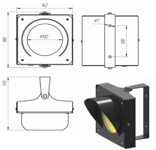
Габариты односекционного светофора 160мм x 160мм x 25мм
